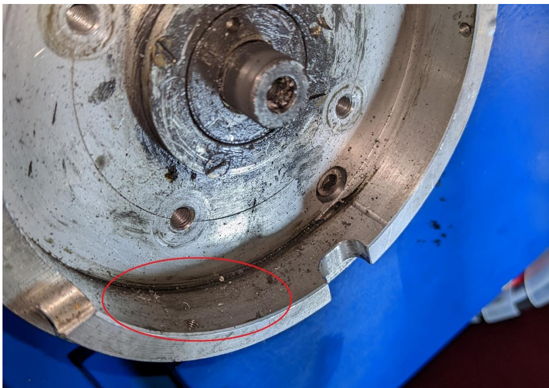
20220805 因 7/28 日赤道儀 Dec 出怪聲，暫時鎖緊。將馬達卸下之後，發現聯軸器上有磨痕，用 T 字六角板手鎖緊後排除。
