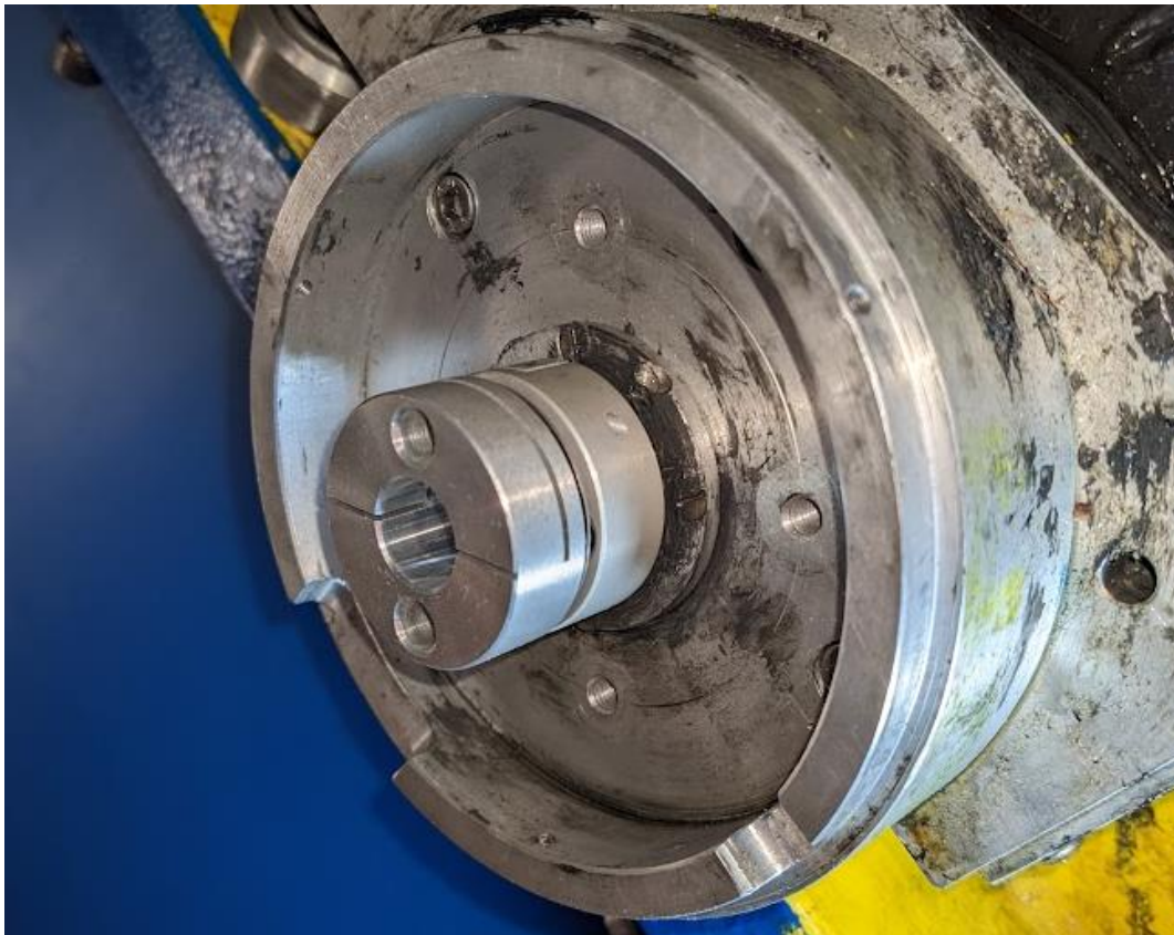
20220805 因 7/28 日赤道儀 Dec 出怪聲，暫時鎖緊。將馬達卸下之後，發現聯軸器上有磨痕，用 T 字六角板手鎖緊後排除。
