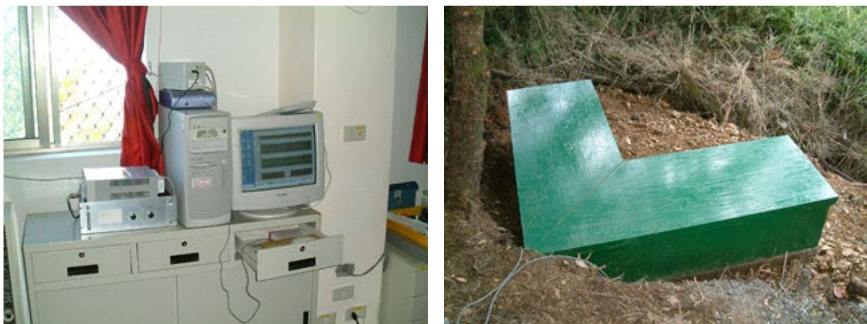
圖八：成功大學安裝於鹿林天文台之極低頻無線電波監測設備。
