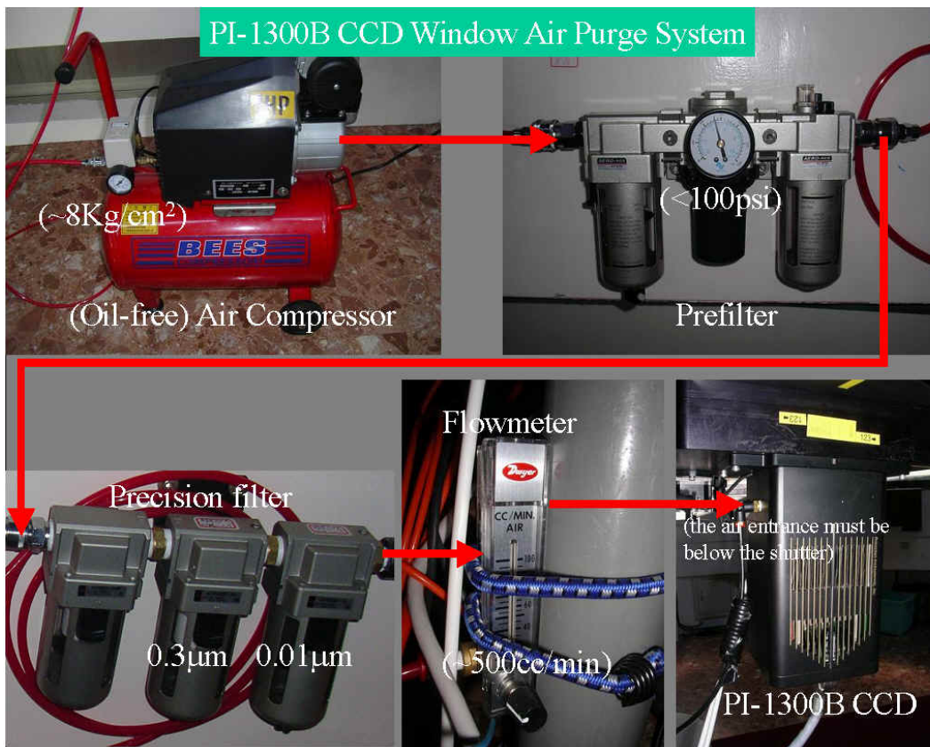
PI 1300B CCD 相機目前使用的 Window 防結露系統圖
