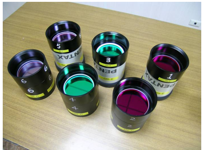
Figure 2. LELIS 系統的三組前置濾鏡，每一組包含 H \alpha 、[OIII]，and [SII]發射譜線及連續譜兩片濾鏡。
