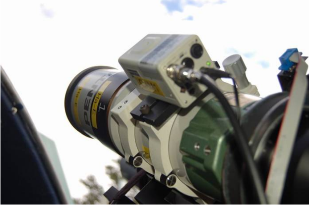
Figure 3. LELIS 系統於圓頂內架上赤道儀，圖中可見鏡筒旁之弱光監控攝影機，以及右上方之遠距調焦裝置。
