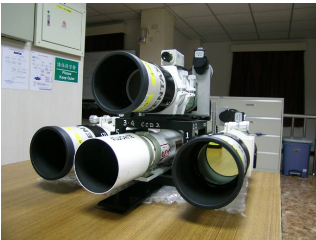
Figure 1. LELIS 系統初步組裝完成，包含三組短焦望遠鏡，成品字形架構，中央下方為導星望遠鏡。
