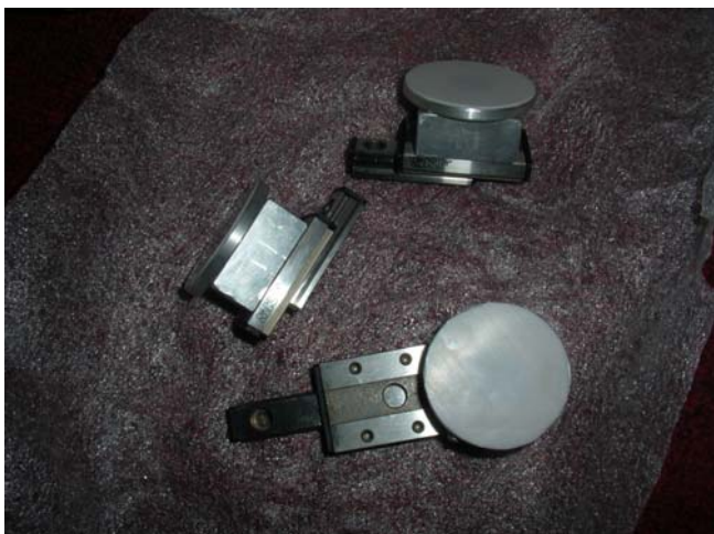
新安裝的線性軸承
