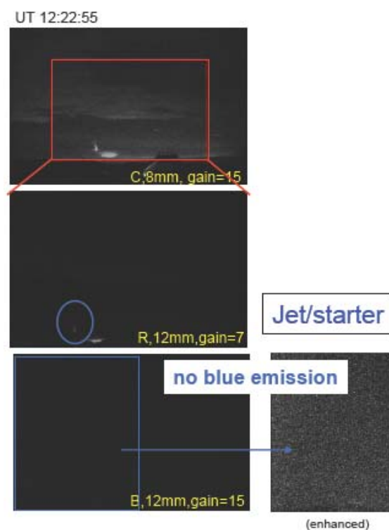
Fig 4. 多波段觀測顯示一般所謂的 Blue starter 或 Blue jet 並無藍光訊號，只有紅光的訊號。
