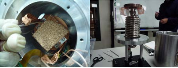
圖 9 新舊分子篩銅網盒安裝方式比較圖。左邊為舊的方式，利用一個銅網盒安裝在下層 Cold-plate 上方，有佔用空間及安裝不易的缺點；右邊為新的方式，將二個銅網盒安裝在下層 Cold-plate 下方的兩端，優點是不佔用空間、且分子篩裝填的容量增加了，可提高水汽吸附的能力。
