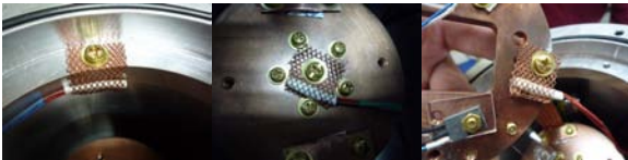
圖 2 三個溫度 sensor 固定的位置，由左至右依序為 TP1、TP2 及 TP3。
