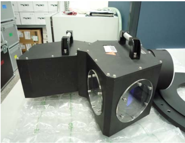
(b) 拆下的光學系統包含分光器和舊修正鏡組兩部份
