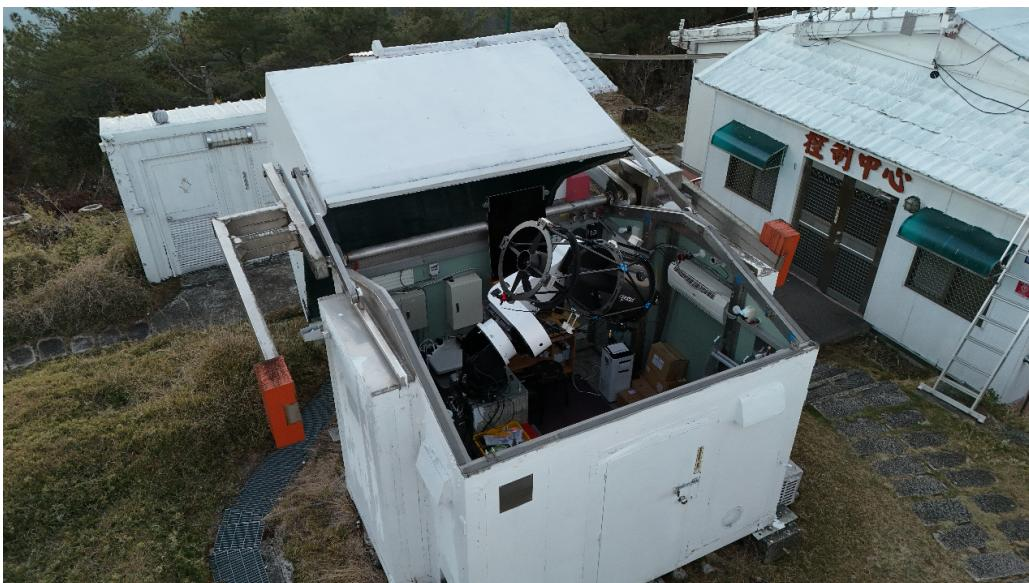
1. LATTE 拿鐵望遠鏡是一台位於 TAOS-A 天文遮罩內的 50 公分望遠鏡 (PlaneWave CDK500 Observatory System)，可完全遠端操作。其視場 (FoV) 為  $44' \times 33'$ ，並可旋轉。像素比例為 0.45 角秒。提供濾鏡包括 Johnson-Cousins B、V、R、I 寬頻濾鏡、H 和 [OIII] 5nm 窄頻濾鏡，以及可見光超寬頻透明濾鏡。BVRI 濾鏡為方形通帶。在典型條件下，B、V、R 波段的 1 小時 5 極限星等 (Vega) 介於 22.5 至 23.2 之間。
