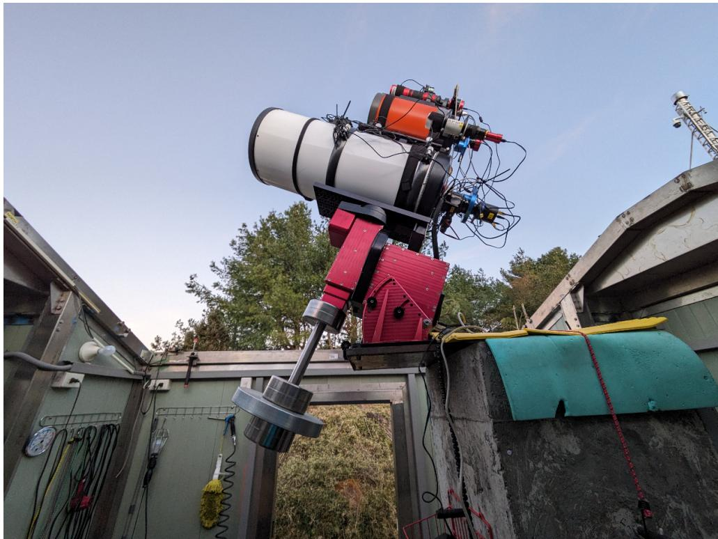
2. 2024 年 9 月 Paramount ME 赤道儀因雷擊 MKS-4000 主機板受損，2024 年 11 月更新為 MKS-6000 控制系統，並加裝 USB 突波保護器以防雷擊。
